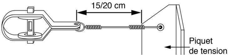
2. Insérer le fil de tension dans le trou du rocher (partie mobile du raidisseur).
